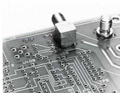
Figure 20. SMA 90° Launcher
